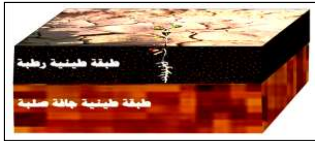
شكل (15) رسم بياني يوضح طبقات التربة في مناطق القيعان / المصدر: عمل الباحث
